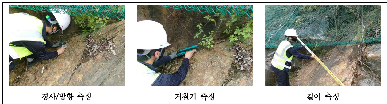
【사진 4.3.5】 불연속면 측정 현황
